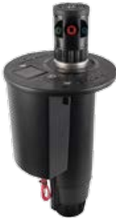
G885E Altura de emergencia: 9,5 cm Altura total: 30 cm Diámetro de la tapa: 18 cm Rosca: 1½" hembra ACME
