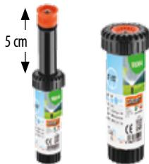
La elección de los materiales y la calidad de los procesos productivos garantizan una fiabilidad absoluta en cualquier tipo de instalación. El diseño especial del perfil de la boquilla permite una lluvia uniforme y equilibrada. Tornillo de regulación de alcance en acero inoxidable. La conexión estándar de 1/2" hembra permite el montaje como recambio en sistemas existentes. Elevación 2" (5 cm). Área regada max. 78 m<sup>2</sup>.
