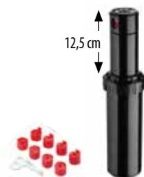
Aspersor de turbina de gran alcance, con toberas intercambiables. Regulable entre 30° y 360° sin extracción de la parte móvil. Ranuras para eliminación de arena que el agua pueda contener. Filtro interno extraíble. Silencioso gracias a su lubricación interna. Se suministra con llave de regulación. Elevación 5" (12,5 cm). Base roscada 3/4" H. Área regada max. 670 m<sup>2</sup>.
