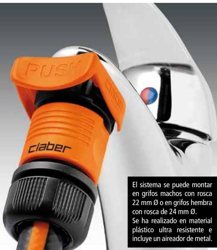
El sistema se puede montar en grifos machos con rosca 22 mm Ø o en grifos hembra con rosca de 24 mm Ø. Se ha realizado en material plástico ultra resistente e incluye un aireador de metal.
